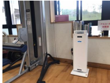
紫外線空気循環器 (エアーリア) 設置
